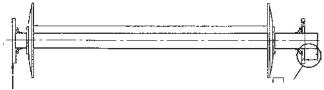
شکل ۵-۳ - شمای اسنو (چله) در ماشین بافندگی
